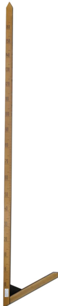
Рейка ледоснегомерная состоит из прямоугольного деревянного бруска и упорной планки-подкоса, жестко прикрепленной к нижнему концу бруска под углом 60°. Рейка и подкос скреплены металлической планкой, концы их снабжены металлическими оковками.
