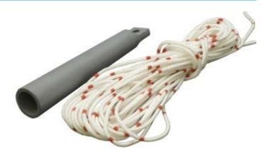
Для производства измерений лот привязывают к разделенному на дециметровые деления лотлиню (хлопчатобумажная или пеньковая бечевка, шнур или веревка толщиной от 5 до 10 мм) или к тросу, намотанному на гидрометрическую лебедку.
