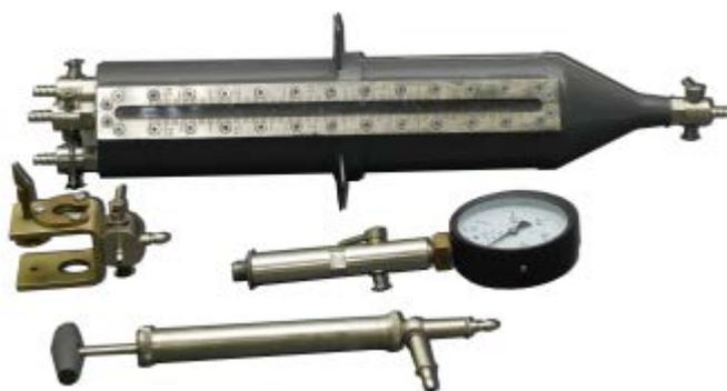
Принцип действия батометра основан на всасывании пробы воды в вакуумную камеру через заборный наконечник со скоростью, близкой к скорости течения воды, путем создания в камере разрежения.
